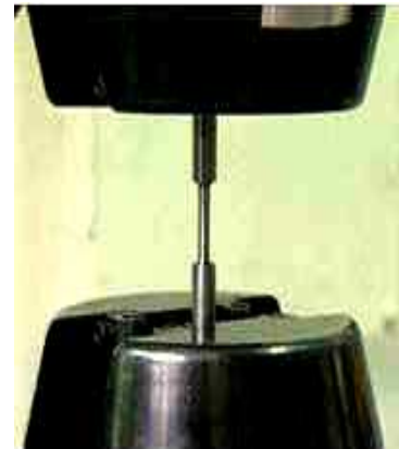
3 - Détail des mors et de l'éprouvette
