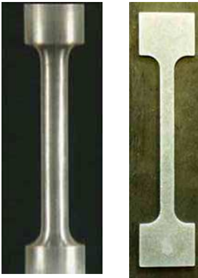
4 - Éprouvettes cylindrique et plane
